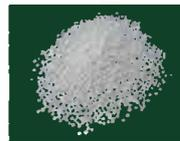
입구온도가 낮고 상대습도가 높을 경우에 수분 흡착 능력이 우수하며, Silica Gel의 단점을 SiO<sub>2</sub>와 Al<sub>2</sub>O<sub>3</sub>를 함성하여 보완 Aluminum Gel에 비해 분진 발생율이 낮고, 2배에 가까운 비표면적을 갖고 있어 수분 흡착력이 높습니다.
