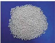
상대습도에 관계 없이 비교적 높은 흡착 특성을 유지하며, 입구 온도에 따라 흡착율이 급격히 감소하는 실리카겔과 알루미늄나겔과는 달리, 흡착율이 서서히 감소하기 때문에, 입구온도가 높거나 상대습도가 낮은 경우에 주로 사용됩니다.
