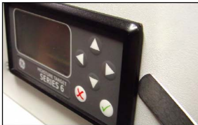
그림 13 가스켓의 압축 정도 측정하기
