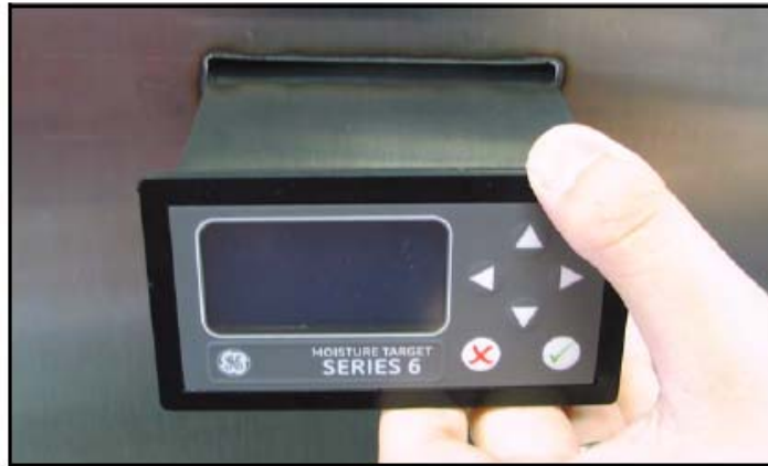
그림 9 패널의 잘라낸 부분에 기기를 밀어넣기
