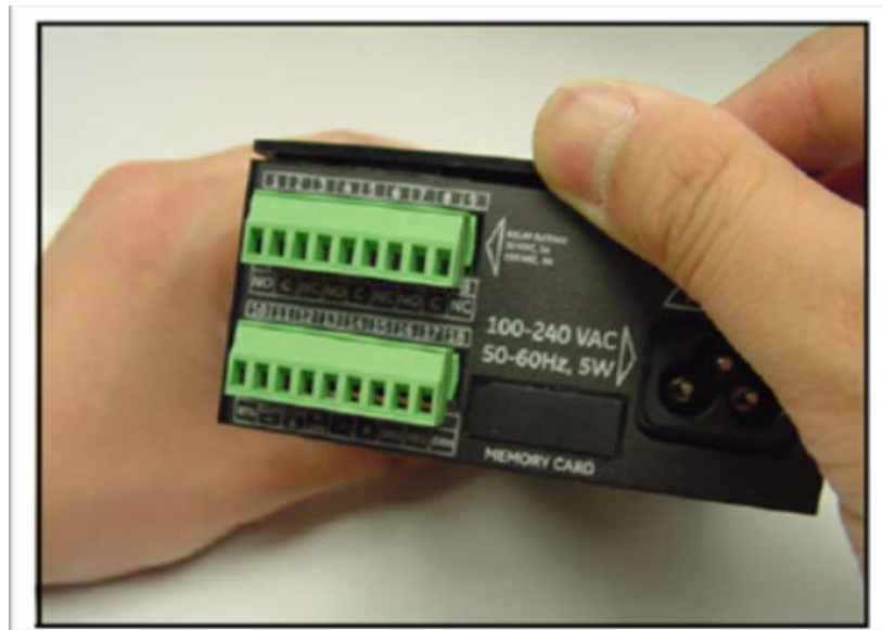
그림 3 : 커버 뒷부분 가장자리를 들어올립니다.
