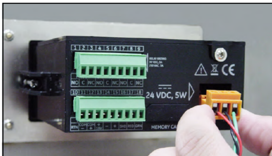
그림 27 DC 커넥터 재 장착
